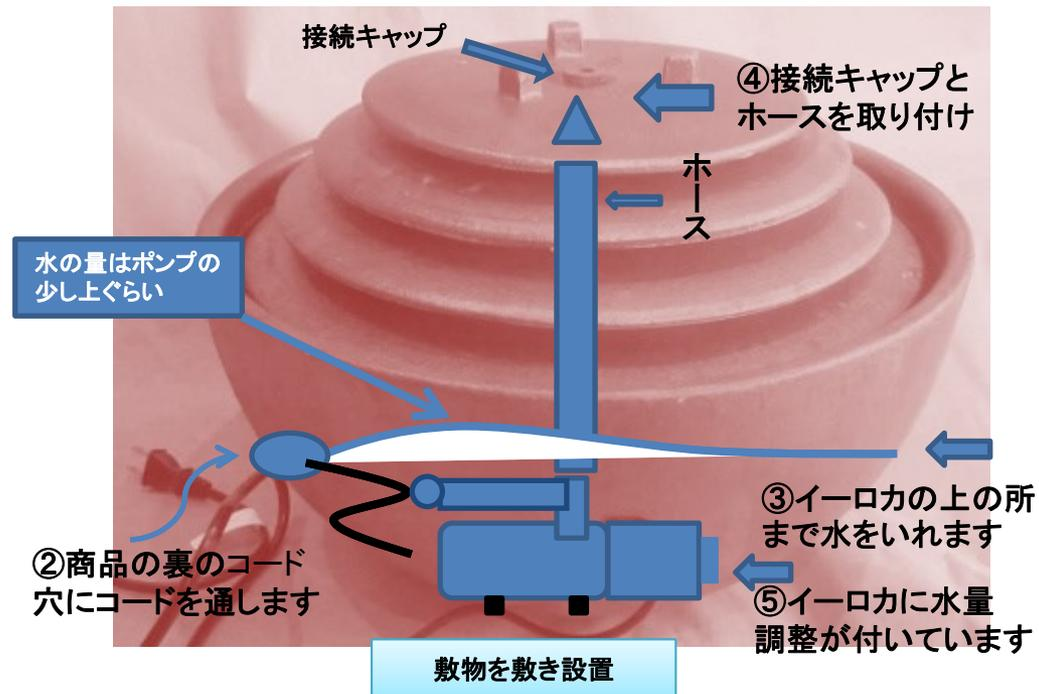
\* 設置の時、水琴窟本体の下に敷物を敷き設置してください。直接設置すると床、畳などに傷、変色(拭きわすれ水、日当たりによる色落ち)する原因になります。\* 設置場所に似合うデザインの受け皿を設置することをお勧めいたします。(素材例、プラスチック、ガラス、石)
